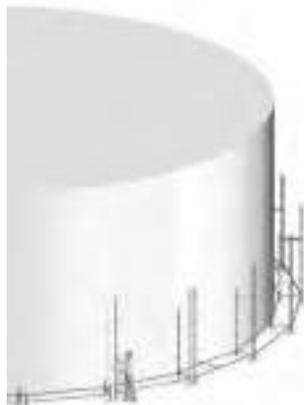
L'implantation se fait avec un socle commun sur la file côté paroi et avec des montants de 3 m sur l'extérieur.
