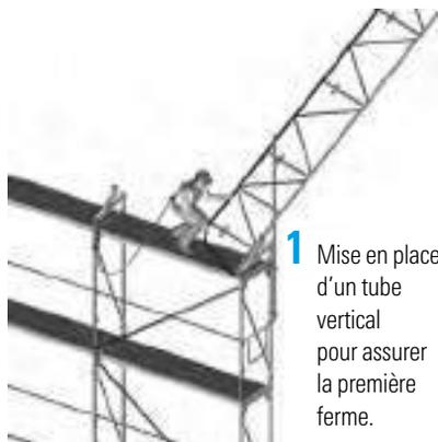
**1** Mise en place d'un tube vertical pour assurer la première ferme.
