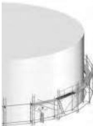
Le support plancher pour échafaudage circulaire (détail 1) permet de constituer des angles de 15° à 45° laissant une totale liberté pour un maillage circulaire.
