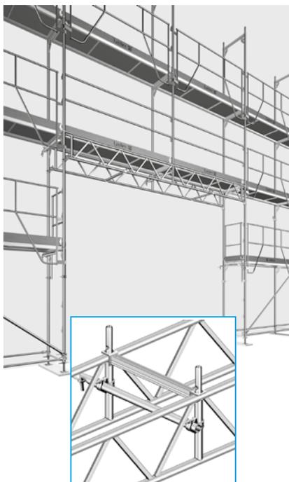
Le montage des poutres se fait par emboîtement sur les goujons des cadres (fig. 1) - à l'aide du plat percé soudé en extrémité de la membrure haute ou par tête clavette (fig. 2).
