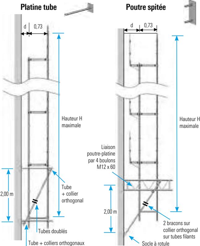
Les montants sont fixés par colliers orthogonaux sur les platines.
