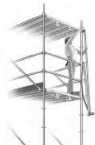
**1** La diagonale, déjà équipée de l'embase et de la poutrelle U est fixée en partie haute sur le montant.
