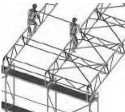
**2** Durant le montage, le monteur s'assurera sur les fermes déjà montées (pas de point d'accroche sur les moises et ciseaux Couvralu).
