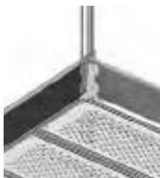
Placez les plinthes derrière les clavettes.
