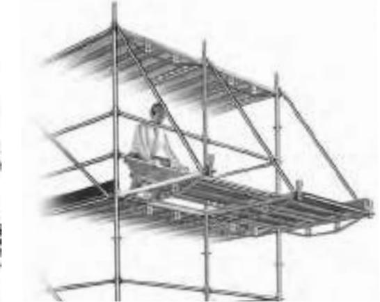
2 Les planchers suivants sont ensuite posés et poussés au fur et à mesure pour assurer un platelage complet.
