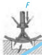
L'implantation sur un vide : elle est dangereuse car elle entraîne une déformation de la planche, voire sa rupture.
