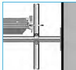
Pour des charges importantes de vent, un demi-collier de blocage assure l'anti-glissement du buton (1 500 daN de capacité utile).
