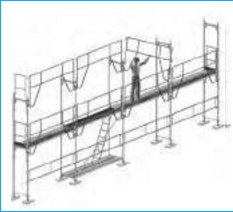
**5** Amarrage et mise en place du pare-gravois, si nécessaire, puis du garde-corps de sécurité du 2<sup>e</sup> étage.
