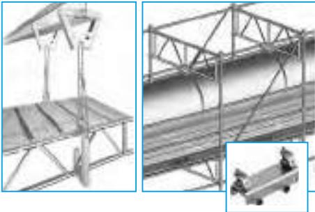
Un système de suspente par mâchoire autobloquante, chaîne et crochet de suspension permet de réaliser simplement des plate-formes suspendues en se reprenant directement sous les profilés ( $F_{\max} = 1500$  daN). Pour le travail sur des canalisations de grand diamètre, un système de cerclage avec sangle textile permet de suspendre l'échafaudage.
