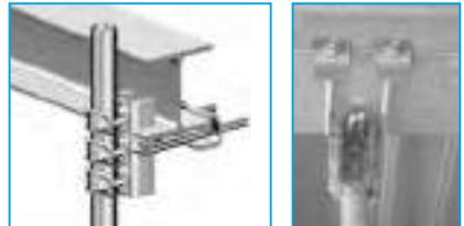
Des colliers spéciaux de suspension permettent aussi de reprendre les montants verticaux et ce pour des charges plus importantes ( $F_{\max} = 1500$  daN). Ils sont équipés de 2 crochets de sécurité pour assurer la tenue horizontale et l'anti-déversement.
