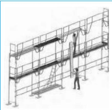
**7** Mise en place des planchers du 2<sup>e</sup> étage à partir du 1<sup>er</sup> étage.
