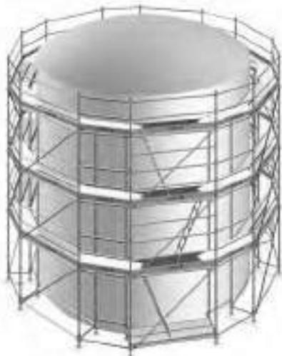
Pour des échafaudages circulaires, des poutres au vent et des butons permettent la stabilité de l'ouvrage (900 daN de capacité utile).
