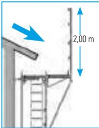
La résistance de la protection\* a fait l'objet d'un P.V. d'essais au CEBTP et s'est vue attribuer la marque NF. Un ancrage par file est nécessaire au niveau du plancher.
