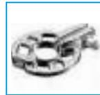
Très pratique, le **disque d'adaptation provisoire** permet de reprendre moises et diagonales à n'importe quel endroit du montant. Néanmoins, sa capacité au glissement est limitée à 600 daN.
