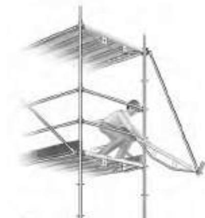
**2** Grâce à sa tête articulée, on peut fixer la poutrelle U puis pousser l'ensemble pour assurer la liaison sur le disque.
